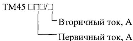
Базовый класс точности может иметь значения 0,5; 1,0 или 3,0 и зависит от мощности измерительной цепи, подключенной к выходу трансформатора. Предельное значение выходной мощности, при котором сохраняется соответствующий класс точности, указано в паспорте для каждой модификации трансформатора
